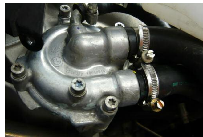
War nicht ganz dicht: Der untere Schlauch war nicht richtig an der Wasserpumpe befestigt. Leicht zu korrigieren – eigentlich
